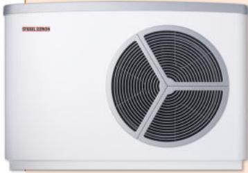
Aufnahme von Energie aus der Umgebungsluft in ein sogenanntes Kältemittel. Durch Verdichtung von diesem findet eine Temperaturerhöhung in den Bereich von 70 °C statt. Diese gewonnene Energie wird im Anschluss an das Heizungssystem abgegeben.
